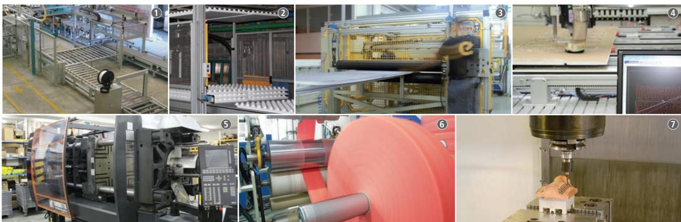
1. Termoformatura 2. Stampaggio EPS 3. Accoppiatura lastre lisce 4. Fresatura cartongesso 5. Stampaggio plastica 6. Produzione striscia perimetrale 7. Lavorazione CNC
