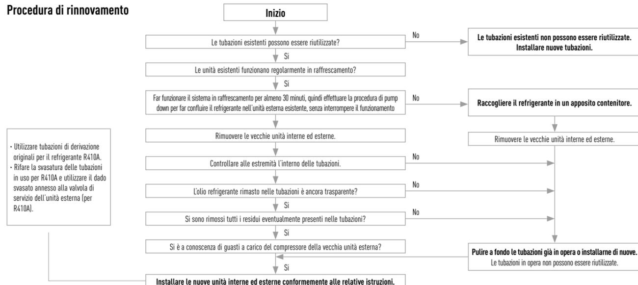
Prerequisiti: - Se il refrigerante in uso è diverso da R22, R407C e R410A, le tubazioni esistenti non possono essere riutilizzate. - Se l'unità in uso viene utilizzata per scopi diversi dalla climatizzazione, le tubazioni esistenti non possono essere riutilizzate.
