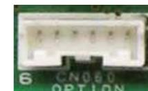
L'accessorio opzionale PAW-OCT (composto da cavetteria opportunamente terminata) da collegare al connettore CN060 sulla scheda, permette di controllare l'unità interna tramite un segnale esterno.
