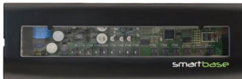
Modulo attuatore della parte idraulica dell'impianto radiante in grado di gestire fino ad un massimo di 8 ambienti, bagni esclusi.
