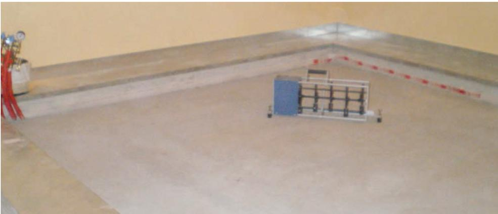
Dopo tre settimane dalla posa del massetto è stata eseguita la prima misurazione sul massetto nudo prima della posa del rivestimento.
