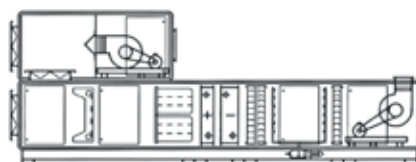
Unità trattamento aria parzialmente sovrapposta.
